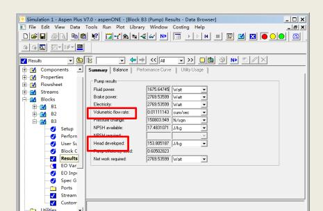
例2】将IS80-65-125的离心泵放置在例1中给出管路中,试计算该离心泵的实际功率,并确定该的安装高度是否合适。
