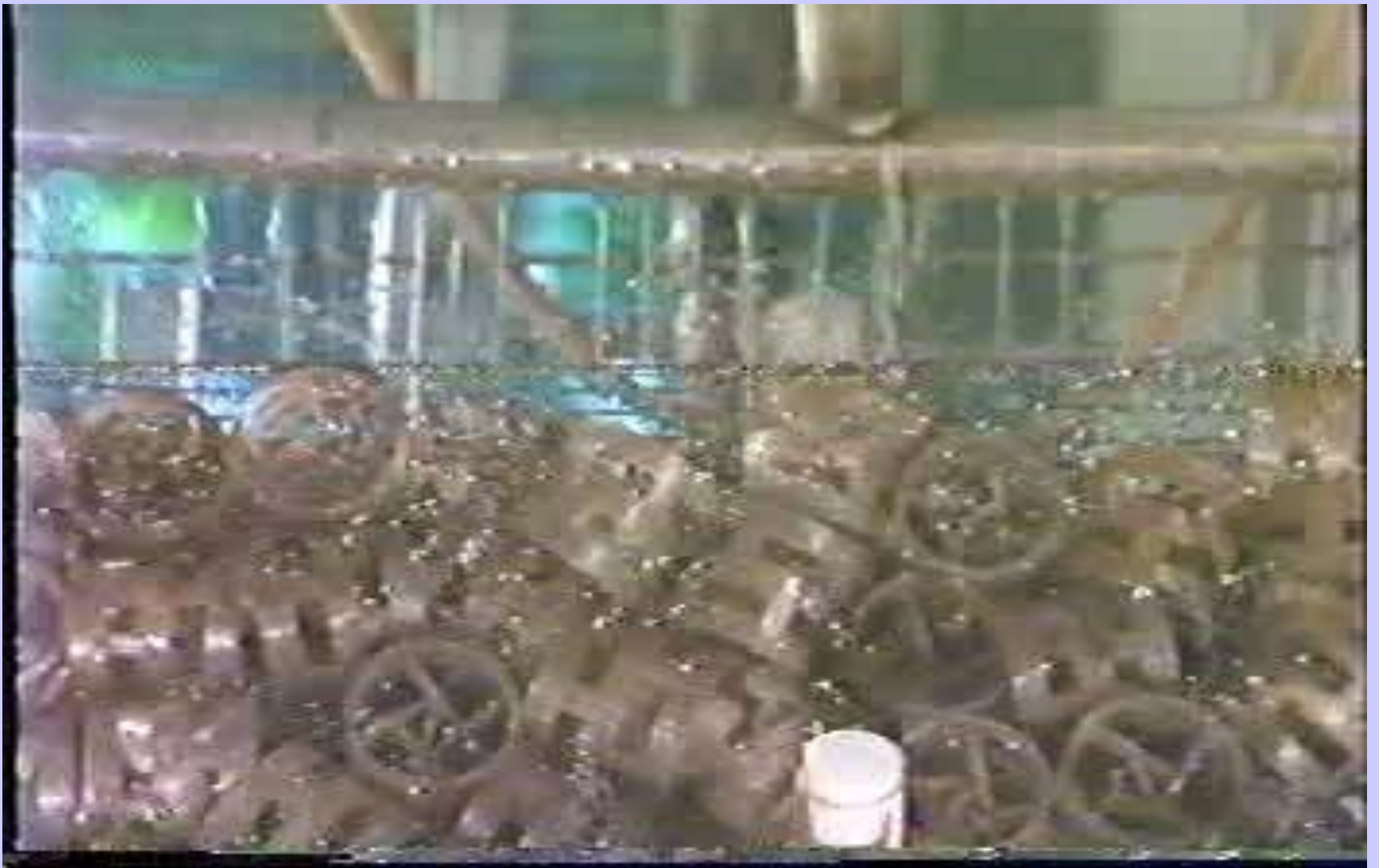
乱堆填料层中液体流动
